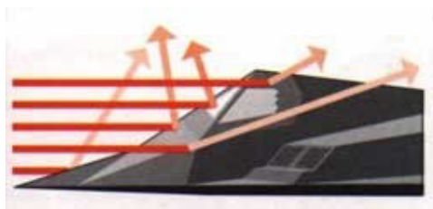
Foto 3. Radarikiirte peegeldus stealth i pinnamoel
